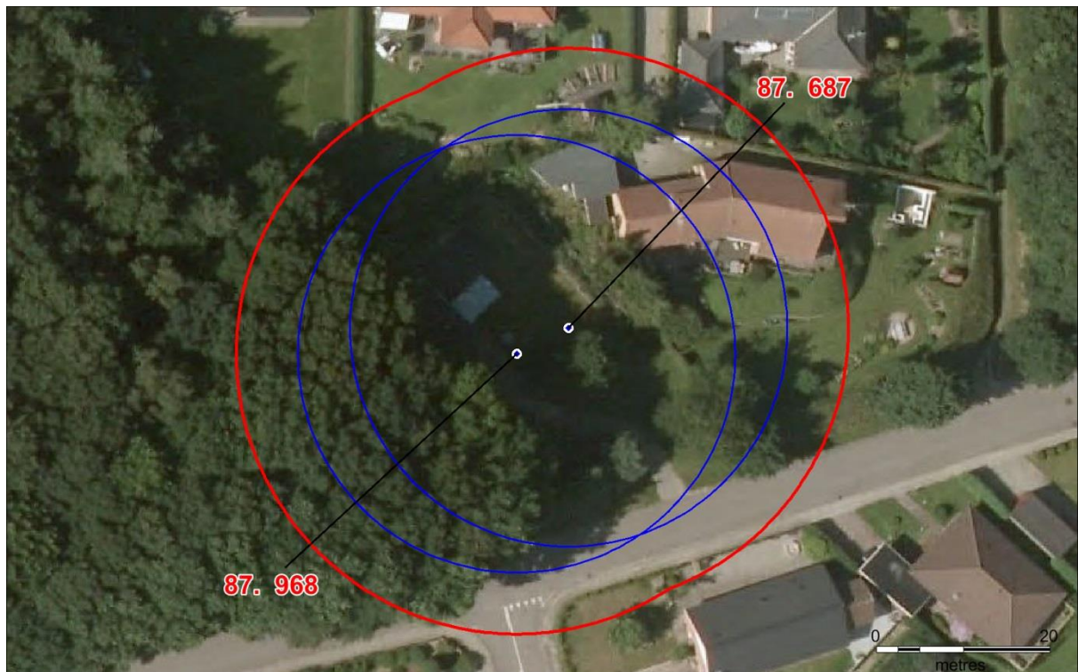
Figur 6.1 viser det boringsnære beskyttelses område (BNBO) inden for den røde afgrænsning. 25 m zonen omkring hver Indvindingsboring, udlagt i forbindelse med "Grøn vækst" er vist med blå afgrænsning.
